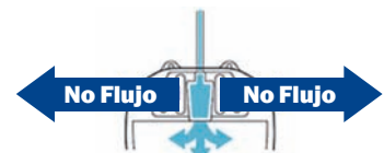
El sistema Ventry Flow. es de flujo unidireccional
